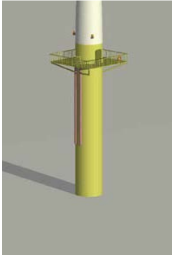
Monopile 2 : 0-20 m depth
